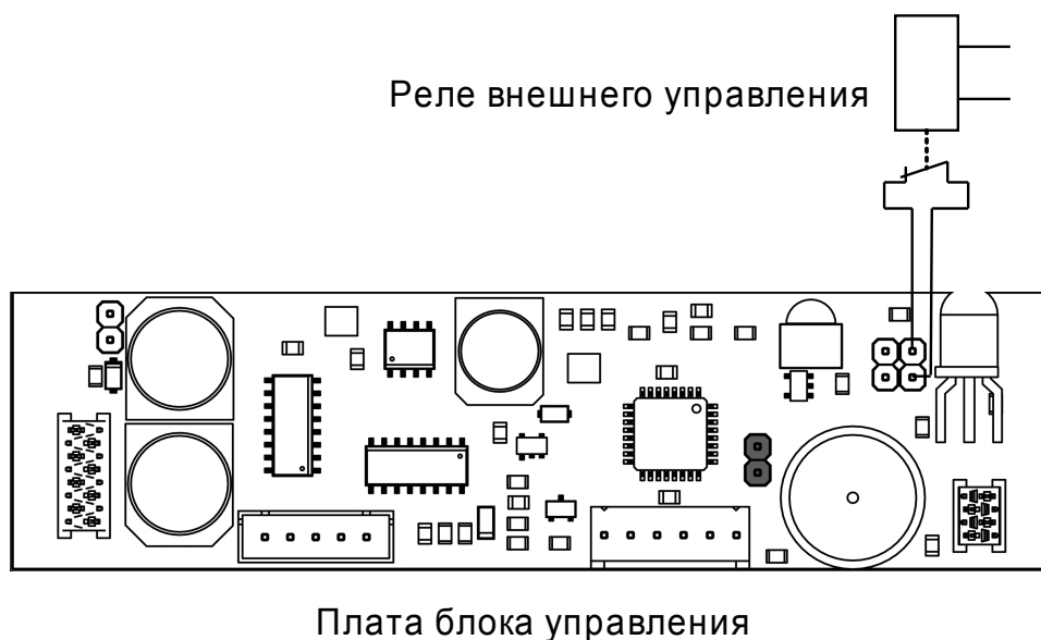
Рис.12. Схема подключения внешнего управления
